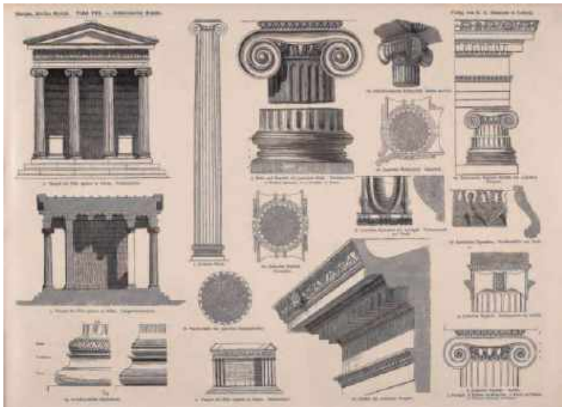
Елементи іонічного ордеру та зразки будівель. Ілюстрація з видання: Menge R. Bilderatlas zur Einführung in die antike Kunst. Leipzig, 1880
